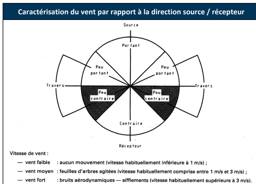
Figure 12 : Caractérisation du vent par rapport à la direction source / récepteur
