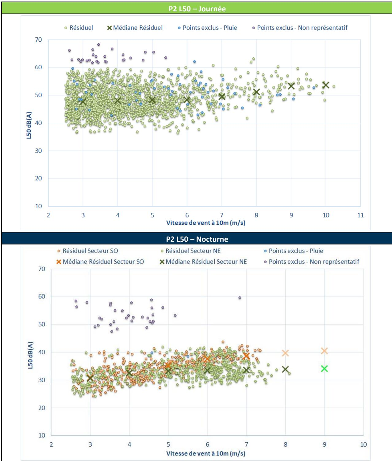
Figure 6 : Bruit en fonction de la vitesse de vent standardisée au point P2
