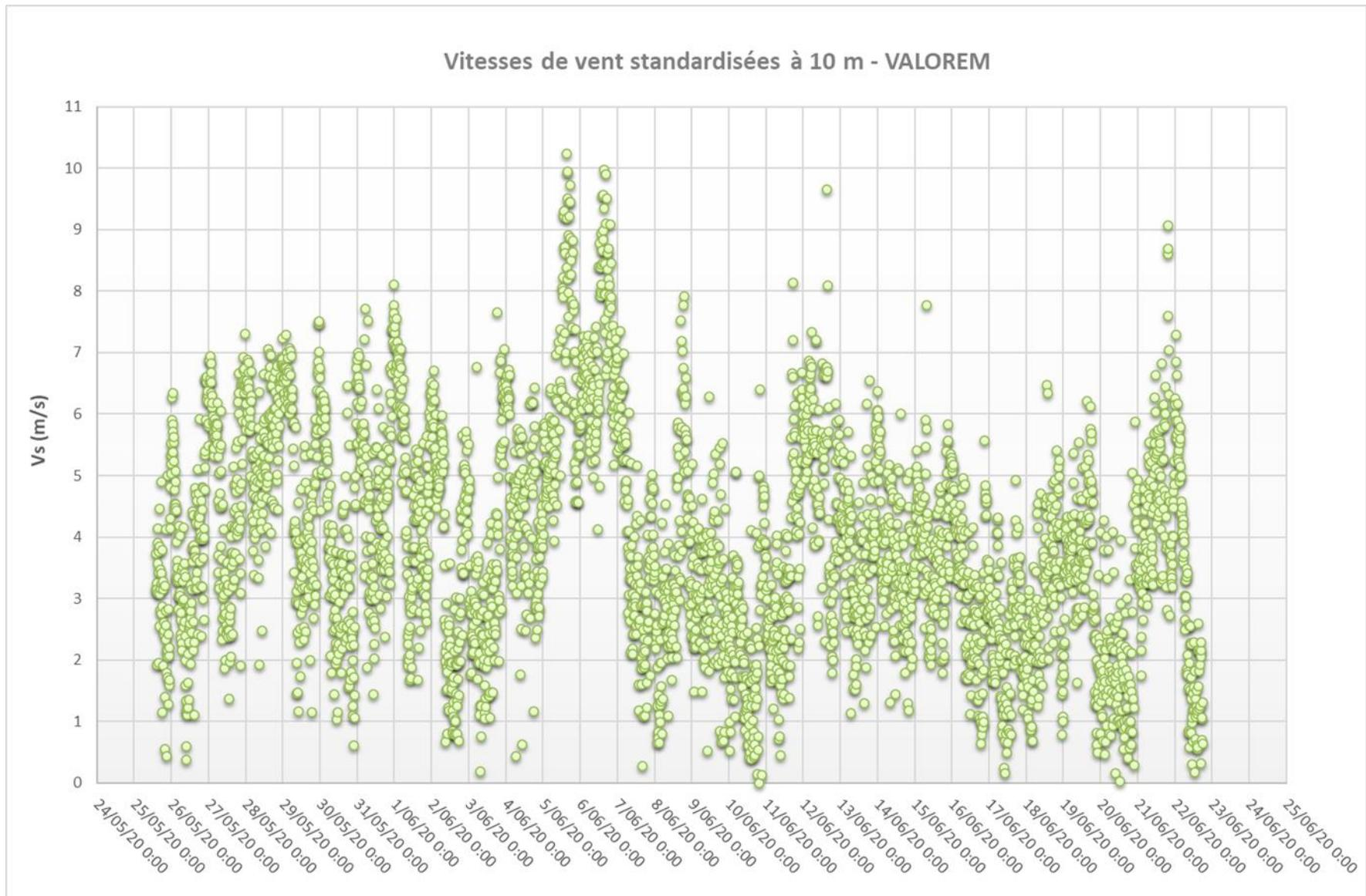
Figure 19 : Vitesse de vent standardisée à partir des vitesses mesurées à 100 m
