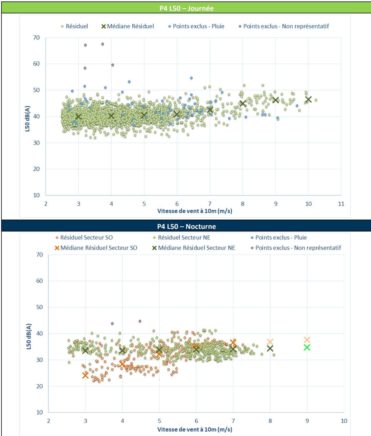
Figure 8 : Bruit en fonction de la vitesse de vent standardisée au point P4
