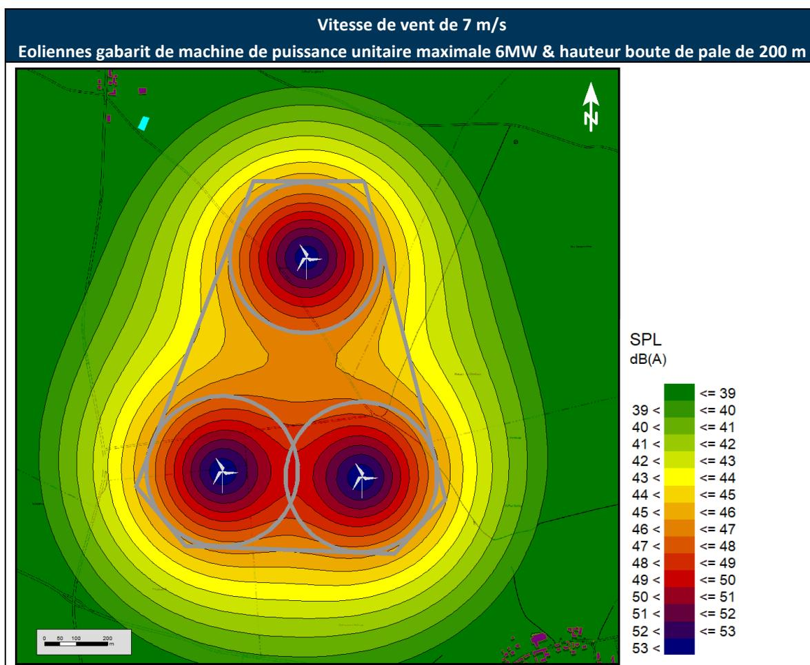
Figure 16 : Cartographie des niveaux de brut maximaux en limite de propriété
