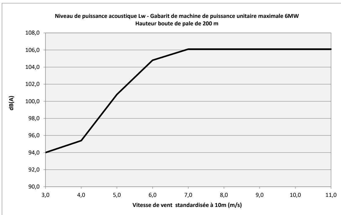
Figure 11 : Niveaux de puissance acoustique gabarit de machine de puissance unitaire maximale 6MW et une hauteur bout de pale de 200 m
