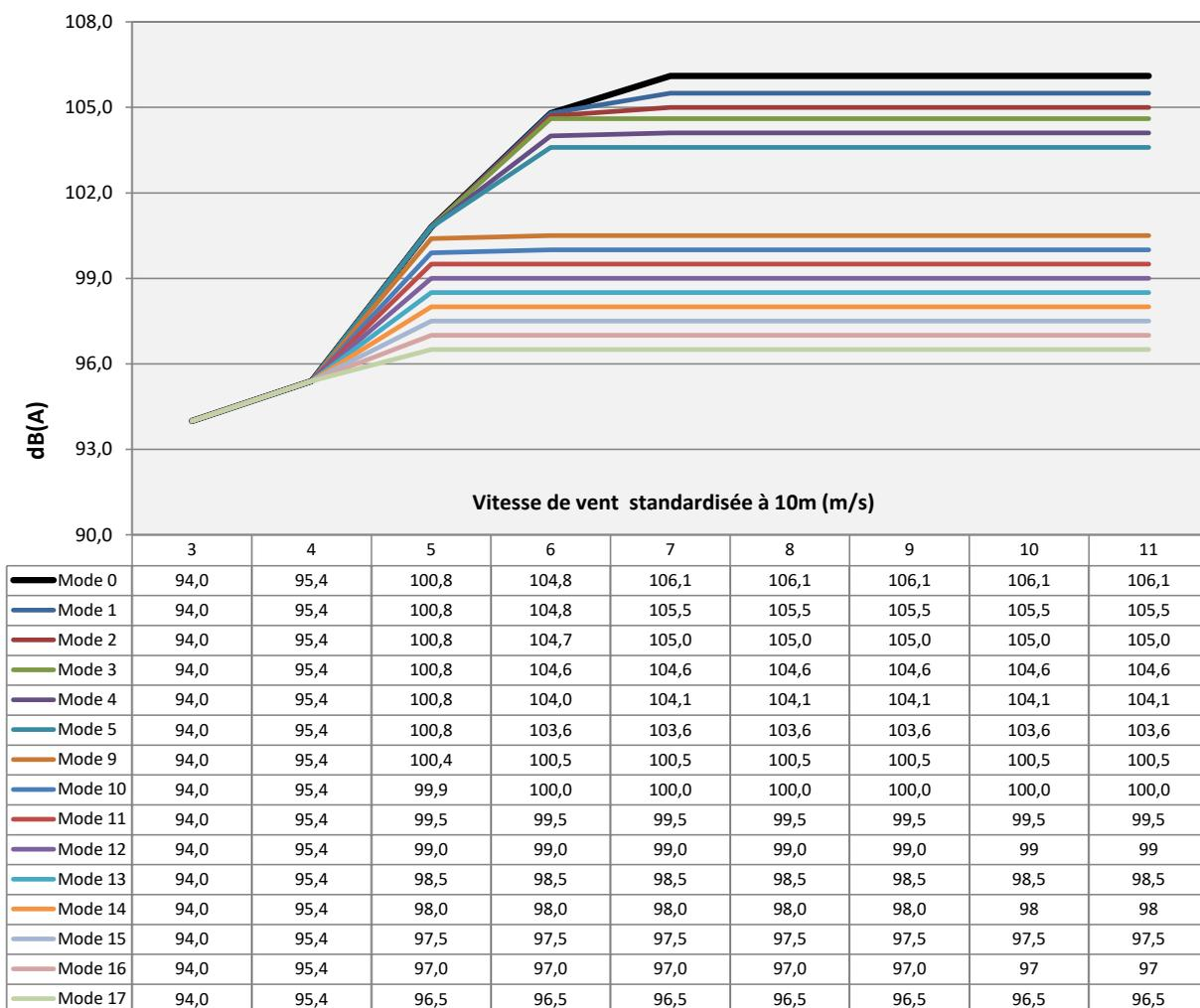
Figure 14 : Modes de fonctionnement gabarit de machine de puissance unitaire maximale 6MW et une hauteur boue de pale de 200 m
